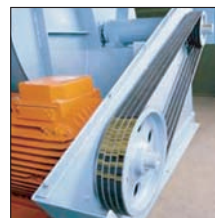
Klíňový řemen má schopnost přenášet vysoké výkony při obvodových rychlostech až do 50 m.s -1 .
